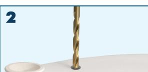
Просверлите отверстие диаметром 10мм на верхней крышке корпуса насоса
