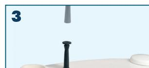
Нанесите силиконовый герметик перед монтажом трубы датчика SANIALARM®
